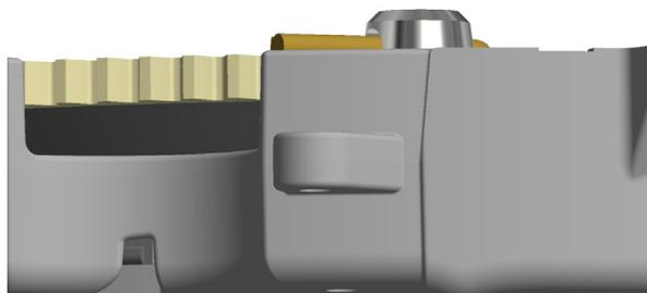
Para verificar, mantenha o disco nivelado contra a placa da unidade central. O número de calços necessários é determinado pelo acréscimo ou remoção dos calços do disco entre os planos inferior e superior. O disco do medidor precisa ser verificado em pelo menos duas posições para determinar a contagem final dos calços. Gire **180°** para verificar.
